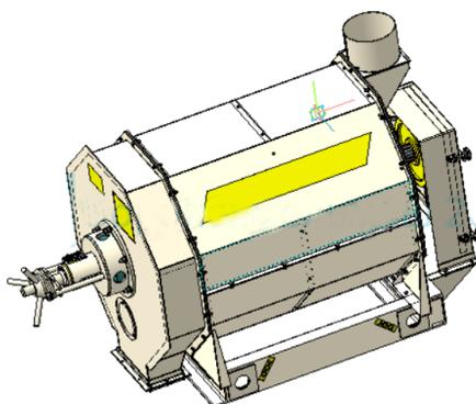
Машина для вытирания из коробочек семян мелкосемянных культур (далее машина) предназначена для вытирания семян из коробочек, содержащихся в поступающем в неё ворохе мелкосемянных культур с влажностью до 25%, прошедшего предварительную очистку в ворохоочистителе.
